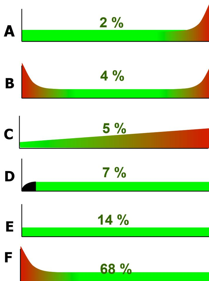
Em nenhum ponto existe a probabilidade “zero” de falha; a falha pode ocorrer em qualquer idade. Portanto, as oportunidades para usarmos as tecnologias preditivas e monitoramento das condições para identificar o surgimento da falha devem ser utilizadas sempre que possível.
